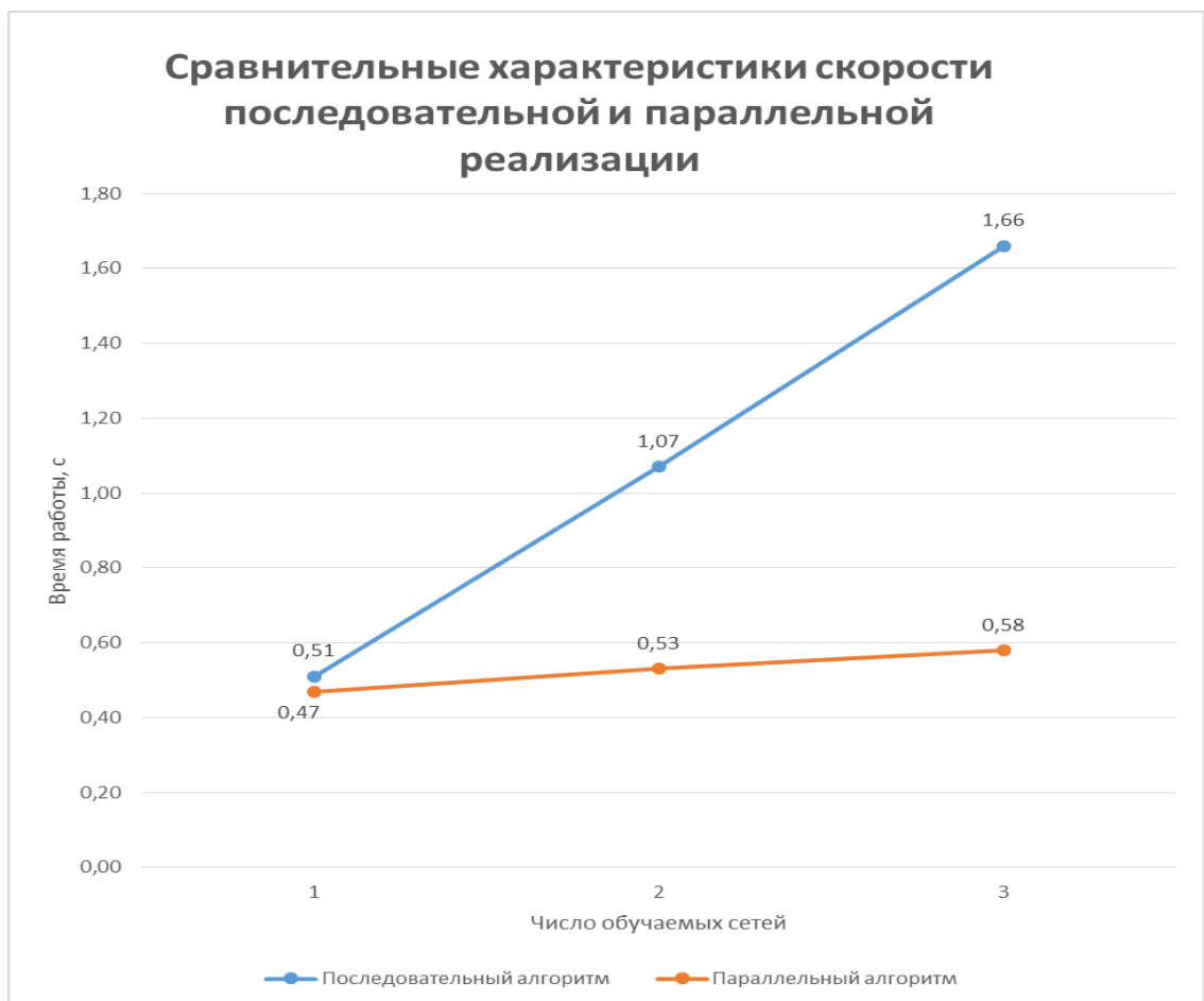
Рисунок 3.2.1. Сравнительные характеристики скорости последовательной и параллельной реализации.
